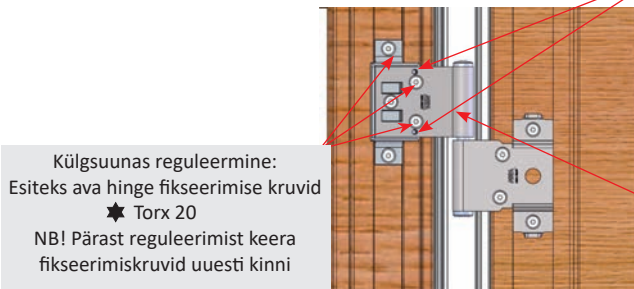
Joonis 7.2. SW17 akna pöördhinge reguleerimine
